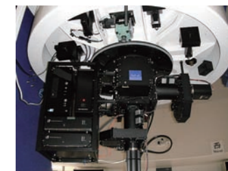
ここに掲載している天体を撮影した荒木望遠鏡・2色同時撮像装置ADLER(黒い部分)
