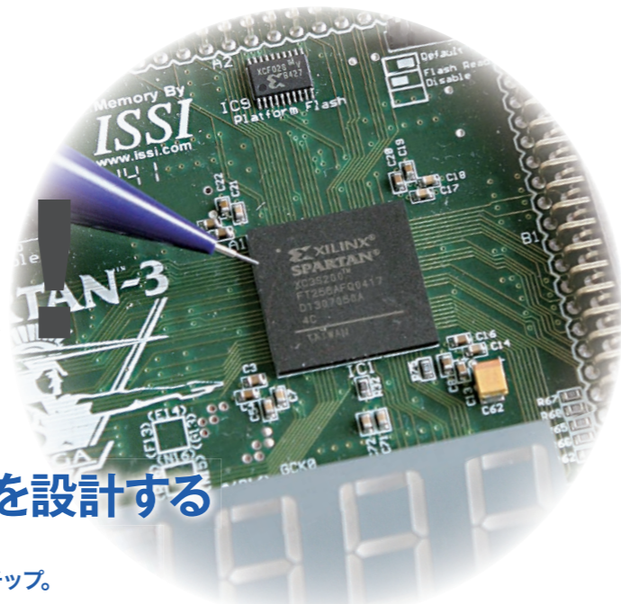
現代のLSI コンピュータによる設計が行われる以前、この小さなチップと同一機能を実現するためには、右下の写真の井上教授が手にしているくらいの大きさが必要だった。
