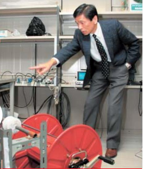
写真注釈) 本学図書館裏、隣地との境界付近にある「地中電磁波観測設備」。センサーシステムを先端に取り付けた信号ケーブルをボアホールに挿入するために、農業用散水ホース巻き取り機が転用されるなど、すべては「工作大好き少年だった」という筒井教授と工学部学生たちの手作りの装置。
