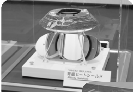
©JAXA 背面ヒートシールド（実物）
