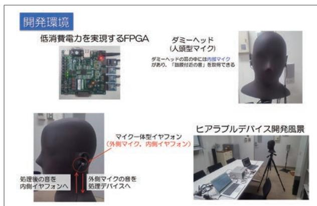
低消費電力を実現するFPGAを用いて、次世代音声音響処理システムの開発を目指す。ダミーヘッドを用いて耳付近の音を取得し、人間にとって都合の良い音に加工した上で、鼓膜へと放射する。
