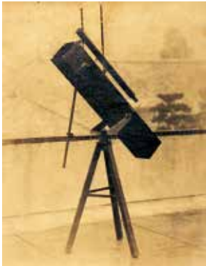
写真1：6.5吋エリソン用の 軽量木製マウント
