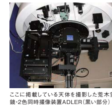
ここに掲載している天体を撮影した荒木望遠鏡-2色同時撮像装置ADLER(黒い部分)
