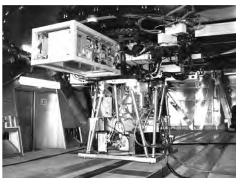
図1. すばる望遠鏡に取り付けられた近赤外線多天体撮像分光装置（MOIRCS）
